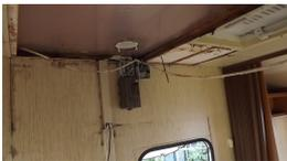
Nach dem Entfernen der Decke im mittleren Bereich habe ich dann plötzlich ein Loch mitten in der Außenhaut des Daches entdeckt! Von außen sah es aus wie ein kleiner Schmutzfleck. Den hatte ich übersehen. Durch dieses Loch hatte das Wasser direkten Zugang in das Innere der Decke. Das Loch sieht man hier nicht. Zum Abdichten habe ich außen ein Aluminiumblech aufgeklebt (Leicht anschleifen, Kleber für Metall auf
