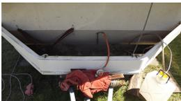
Da der Gaskasten unter die Profilgummis gelegt wird, habe ich mich erst mal mit der Reparatur desselbigen beschäftigt. Das Bodenbrett war völlig morsch und konnte den Inhalt des Gaskastens nicht mehr tragen. Überdies funktionierte die Befestigung der Gasflaschen nicht wie gewünscht.
