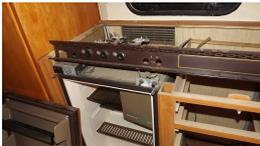
Leider hat die Gas-Funktion des Kühlschranks mittlerweile ihren Geist aufgegeben. Neue Kühlschränke kosten Traumpreise, also wird repariert. Um an Ventil und Brenner zu kommen, muß der Kühlschrank ausgebaut werden. Das ist im Prinzip ganz einfach. Vorher muß die Edelstahlspüle ausgebaut werden. Dann muß die
