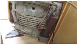
Hier sehen wir die Rückseite des Kühlschranks. Rechts unten im grauen Gehäuse befindet sich Ventil und Brenner.
