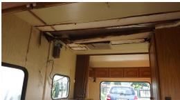
Beim Öffnen der Decke kam mir erst mal ein Schwall Wasser entgegen. Die Decke war so verfault, daß das Material der Verkleidung schleimig und weich wie Gummi war.
