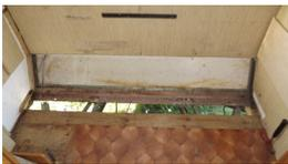
Hier habe ich den verfaulten Boden im Bug über die gesamte Breite entfernt. Dazu mußten vorher alle Metallteile (Kurbelstützen, Rahmenbefestigung, Gaskastenbefestigung) entfernt werden.
