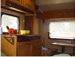
Der Küchenblock in der Mitte des Fahrzeugs. Der Hängeschrank darüber muß ausgebaut werden. Auch die Hängeschränke links davon müssen ebenfalls ausgebaut werden um die Decke öffnen zu können.
