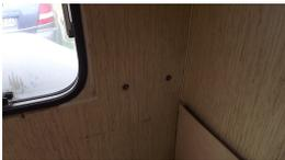
Die innen liegenden Schraubenköpfe sind aber bündig mit der Wand. Außen sind die Muttern total festgerostet. Da muß man halt außen die Schrauben und damit den Griff mit einem Winkelschleifer kaputt schneiden.
