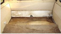
Auch der hintere Boden ist an der linken Ecke verfault.
