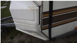
Wie man erkennen kann hat Knaus den unteren Teil des Gaskastens unter den Profildgummi gelegt und dann alles mit etwas größeren Schrauben an der Kantenleiste befestigt. Wie die Alu-Profil-Schiene mit dem Gummi bei diesen unebenen Flächen dichten soll wird sich noch zeigen.
