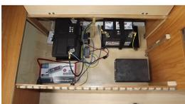
Der zugehörige Batteriekasten enthält 2 Batterien. Die vorhandene kleine Batterie wird später gegen eine große ausgetauscht.
